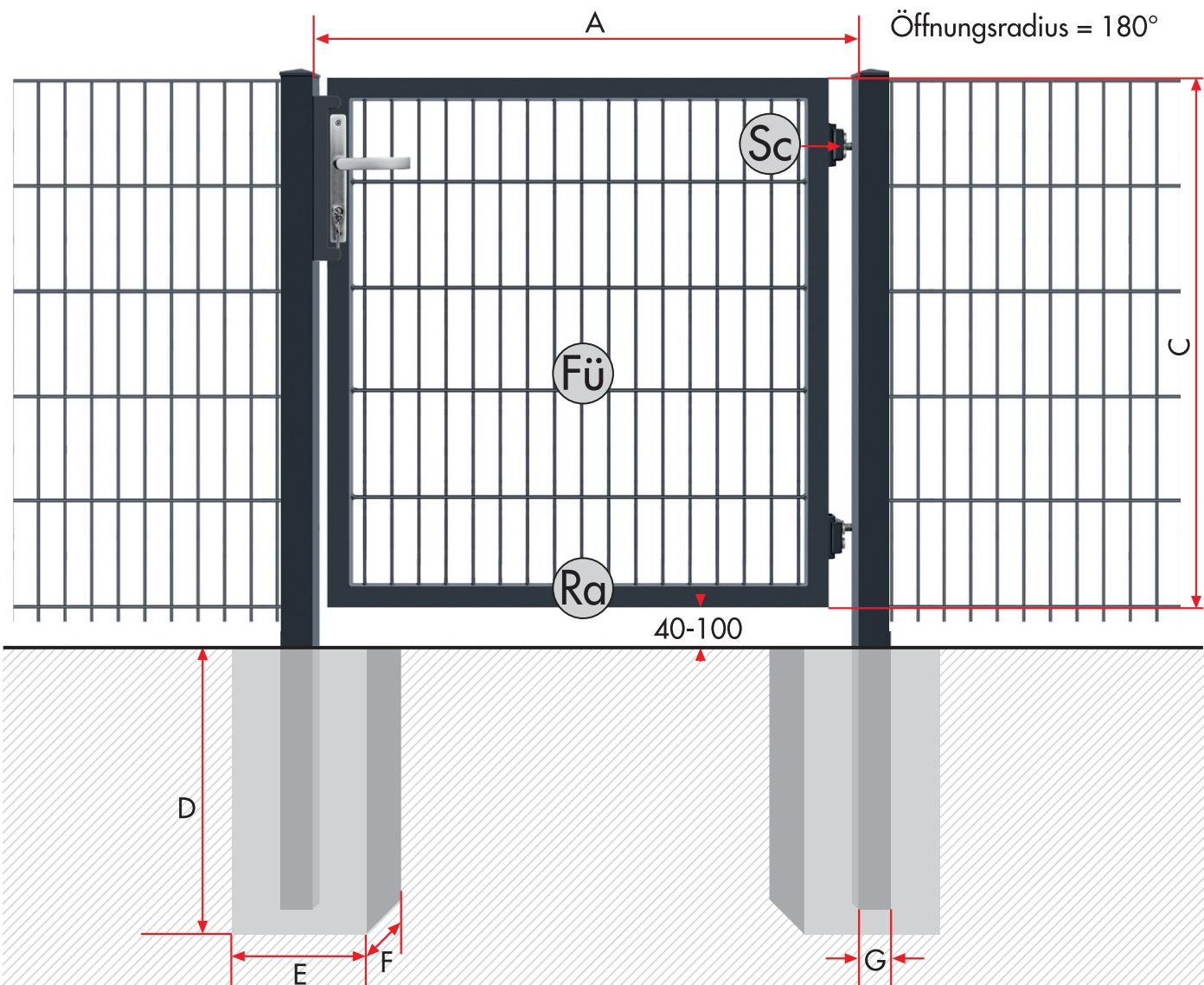
Flexibel rechts und links verwendbares Anschläge- und Scharniersystem,
